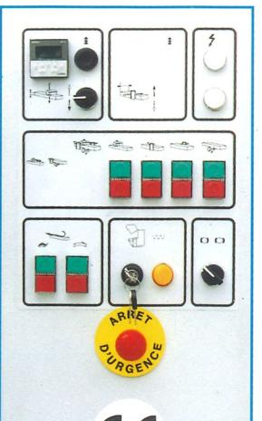
**P**upitre de commande. Montée-basse de la poutre électrique avec réglage fin par impulsion et visualisation électronique.
