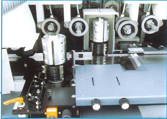
**T**oupies équipées d'un empilage d'outils à profiler de hauteur 90 mm et diamètre 180 maxi pouvant s'escamoter sous le plan de travail afin de calibrer avec l'outil standard diamètre 125 et hauteur 130 mm.
