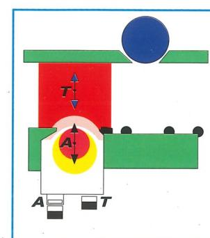
**E**xtraction des bois par système DUOMATIC motorisé dessous par cardan homocinétique. Timber outfeed by motorised DUOMATIC system. Wear free cardans shafts. Vorschub über Kardanwellen mit verschleißbarer Kraftübertragung, Angetriebenes Auszugswalzen System DUOMATIC.
